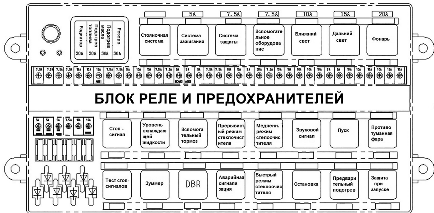
Схема расположения электрических компонентов в распределительной коробке
