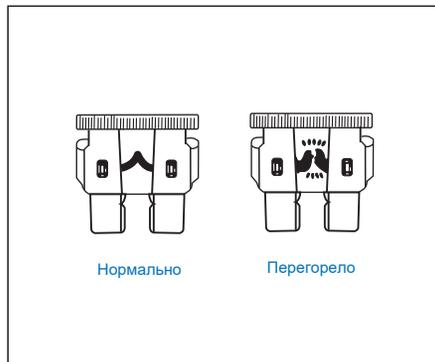
3. Используйте съемник предохранителей, чтобы удалить перегоревший предохранитель. Съемник предохранителей расположен в крышке ящика предохранителей в переднем отсеке.
