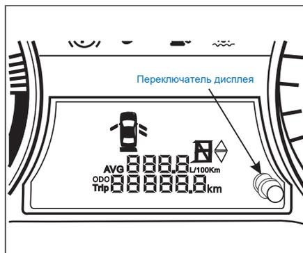
Обнуление информации: «Средний расход топлива (AVG)» и «Промежуточный пробег (Trip)» можно обнулить длительным нажатием (более 2 секунд).
