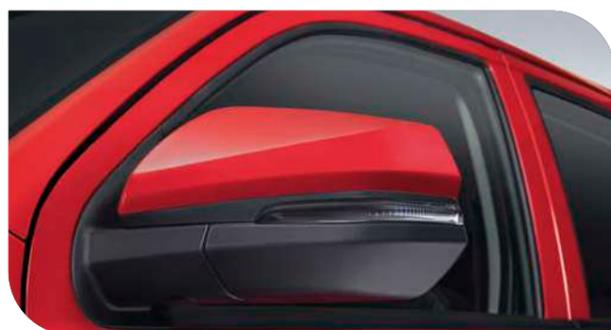
Зеркала с подогревом, электрорегулировкой и повторителем поворота
