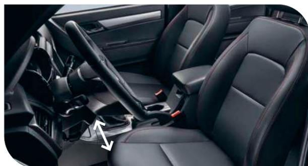
Регулировка рулевого колеса по углу наклона
