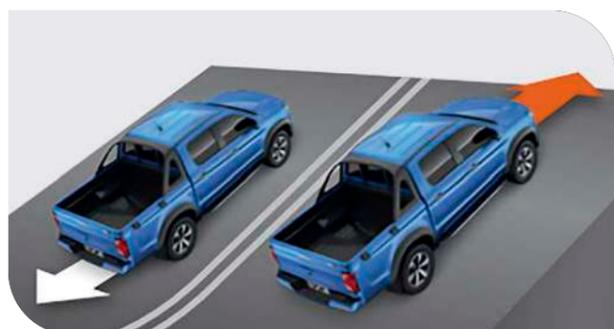
Система помощи при старте на подъёме
