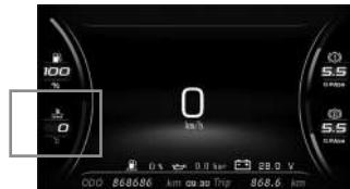
**Внимание:** Когда температура охлаждающей жидкости превышает 108 °С и держится более 30 секунд, загорается индикатор перегрева и звучит звуковой сигнал.
