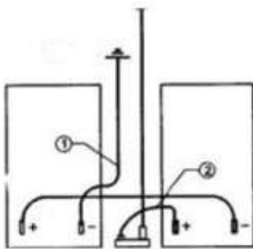
1. Провод питания отрицательного полюса аккумулятора
