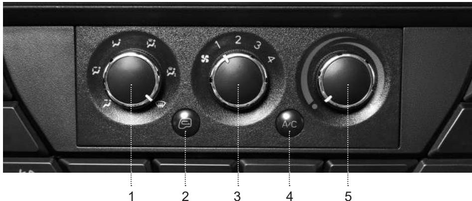
1. Поворотный переключатель распределения потоков воздуха
