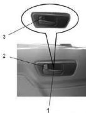
1. Ручка открытия двери внутри автомобиля
