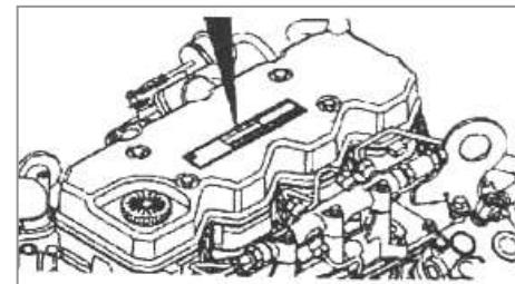
В соответствии с серийным номером двигателя компания Соллерс предоставляет возможность поиска каталожных номеров деталей и другую информацию, необходимую для заказа запасных частей и проведения ремонта.
