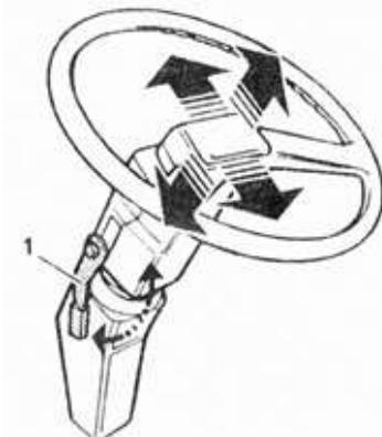
1. Рычаг блокировки рулевого колеса
