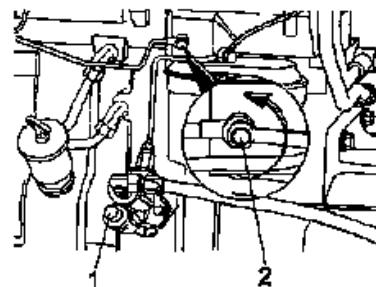
1. Топливоподкачивающий насос
